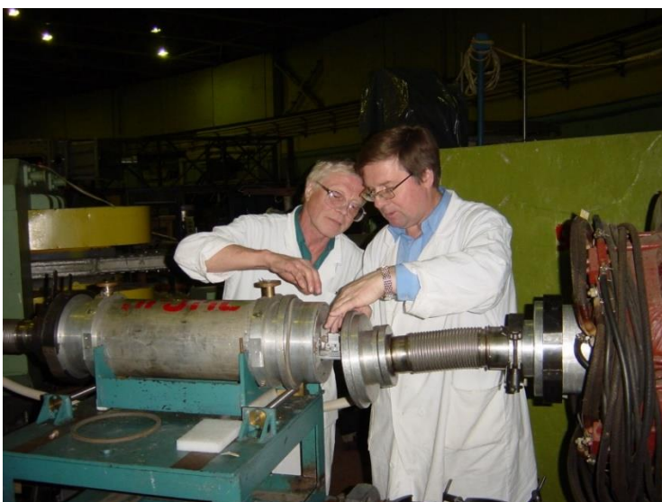
В.А. Горбунов и Ю.М. Иванов, установка кристалла на пучок протонов с энергией 1 ГэВ, 2005–2006 гг.
