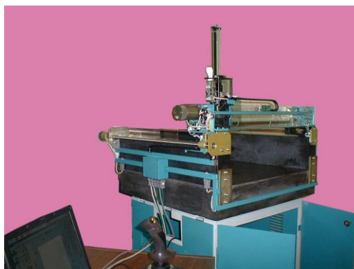
Рис. 5. 3D НАНО КИМ – координатно-измерительная машина с разрешением 10 нм
