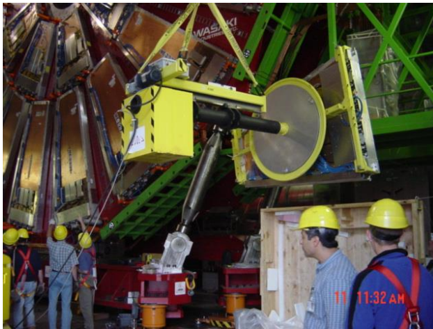
Процесс установки мюонной камеры на мюонный диск в наземном зале CMS
