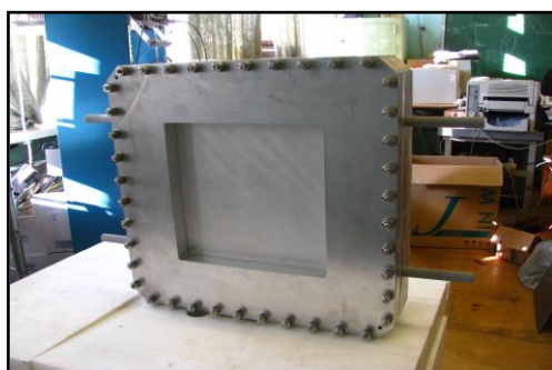
Рис. 16. Детектор тепловых нейтронов 300×300 мм (вверху). Асимметричное рассеяние нейтронов на фторопластовой пленке ДО ее деформации и ПОСЛЕ (внизу)
