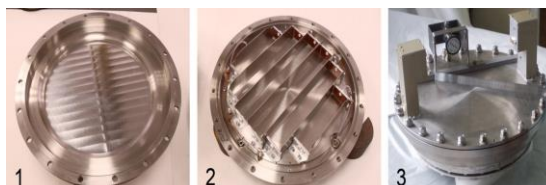
Рис. 17. Детектор ультрахолодных нейтронов. Диаметр – около 300 мм. (1) – верхняя часть детектора; (2) – нижняя часть детектора; (3) – детектор в сборе
