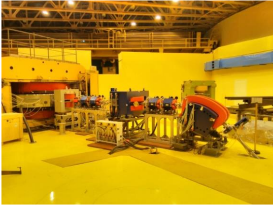
Циклотрон Ц-80. На переднем плане виден поворотный магнит, направляющий протонный пучок вниз в подвал экспериментального зала к мишенным станциям радиоизотопного комплекса РИЦ-80
