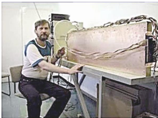
С.А. Гец. Измерение шага намотки проволок
