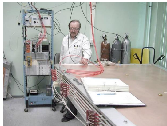
В.В. Голубев. Высоковольтное тестирование камеры
