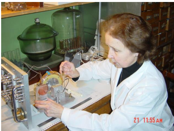
Л.А. Вайшнене, измерение альфа-активности материала мюонных камер, 2004 г.
