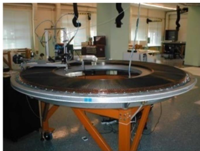
Рис. 5 Сборка модулей детектора TRT в ПИЯФ. 4-слойный модуль подготовлен к натяжению нитей.
